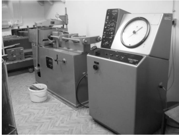
Rys. 1. Użyty do badań średniowymiarowy aparat bezpośredniego ścinania Fig. 1. Medium-size direct shear box apparatus used for tests
