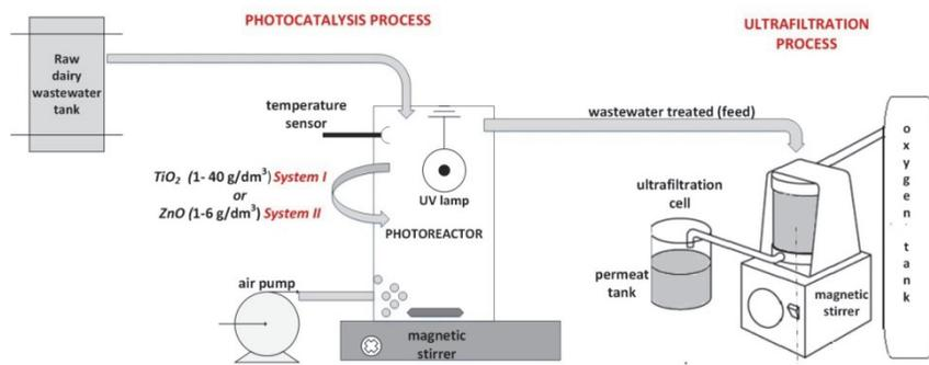
**Rys.1.** Schemat oczyszczania ścieków mleczarskich w procesie fotokatalizy
