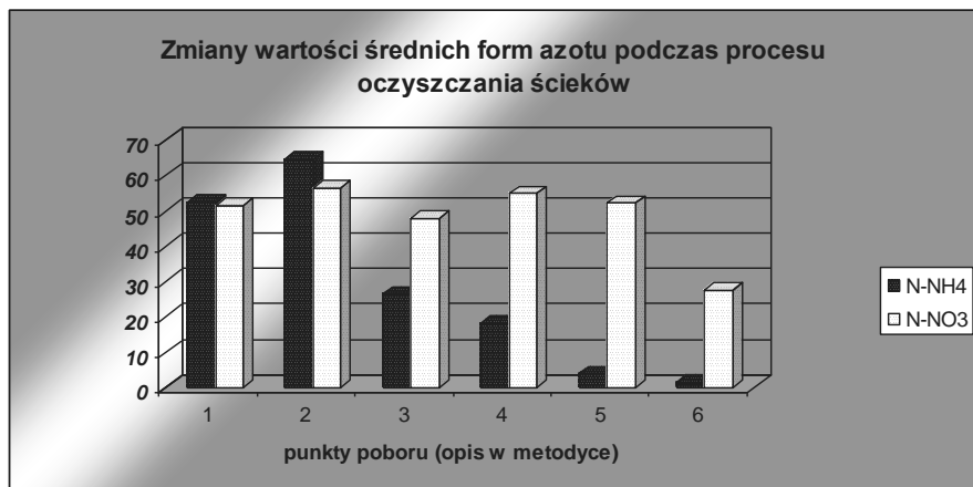
Rys. 3. Zmiany wartości średnich form azotu podczas procesu oczyszczania ścieków Fig. 3. Changes of mean values of nitrogen forms during wastewater treatment
